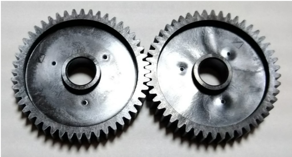
左) 射出圧縮成形 (JIS精度：5-6級) 右) 通常成形 (JIS精度：級外)
